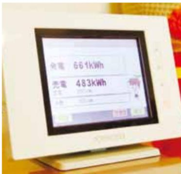
リアルタイムの発電量だけでなく、月の電気代も表示する発電モニター
